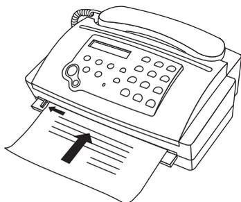
Nehmen Sie die erste Seite des Dokuments und halten Sie sie **mit der Schriftseite nach oben**, wie in der Zeichnung beschrieben. Schieben Sie die Vorlage entlang der Anlegerippe auf der linken Seite des Einzugschachtes in das Faxgerät, bis Sie einen Widerstand fühlen. Warten Sie einen Augenblick, das Dokument wird nun vom Transportmechanismus erfaßt und etwas eingezogen. Schieben Sie es nun nicht weiter hinein, da sonst beim Senden oder Kopieren der oberste Teil des Dokuments fehlt.
