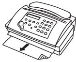
Ist die eingestellte Anzahl von Klingesignalen vorüber, so schaltet sich automatisch der Faxempfang ein. Ein Anrufer, der auf einem eventuellen Anrufbeantworter keine Nachricht hinterlassen hat, wird mit dem Faxgerät verbunden.
